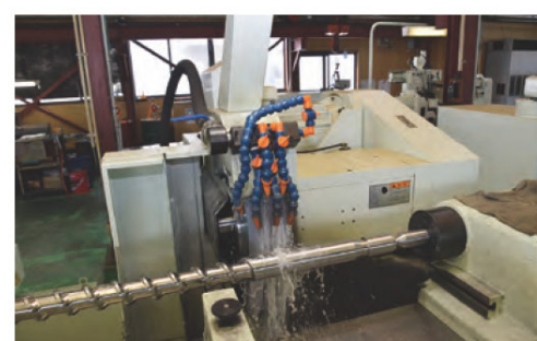
研磨シミュレーションを経て従来よりも精度の高い研磨が可能になった
