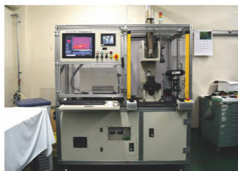
試作開発した金属／熱可塑性CFRP融着締結接合装置
