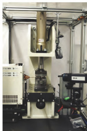
CFRTPリベットを加熱・プレスして冷却
