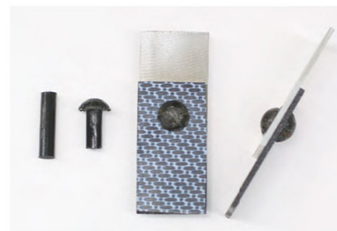
CFRTPリベットによる締結
