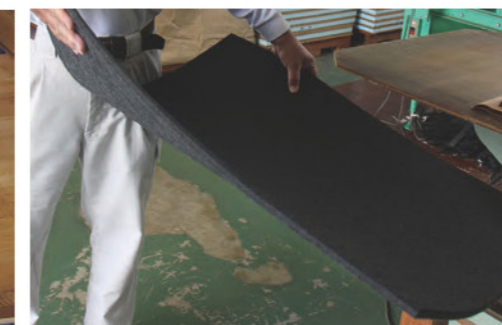
フェルトを圧着させて12mmほどの厚さにし、強度と柔らかさを両立させたふわっと畳の芯材
