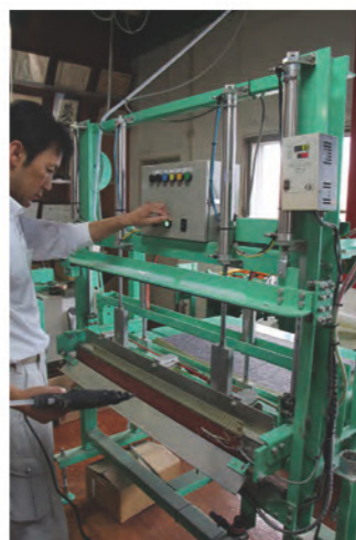
畳と芯材を挟んで貼り付けて作る東海機器工業㈱の「ヒートプレス」
