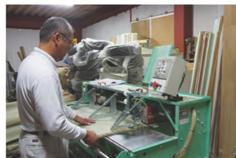
いぐさの巾を裁断する東海機器工業㈱の「自動畳表裁断機」。これまでは包丁を使って手で裁断していた
