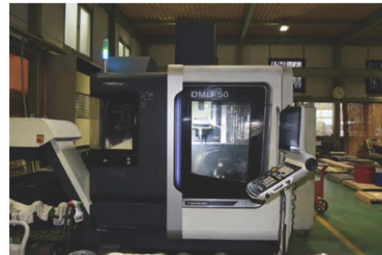
3次元の複雑形状を削り出せる5軸の工作機械を導入
