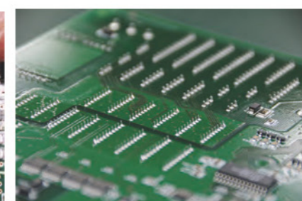
局所ハンダ付け装置で製造された基板
