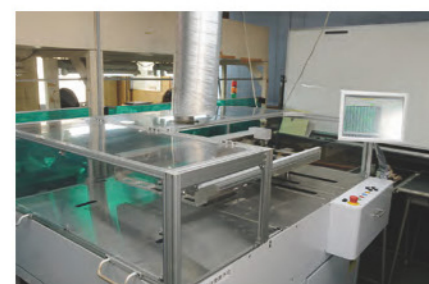
新たに導入した部品の後付けができる局所ハンダ付け装置
