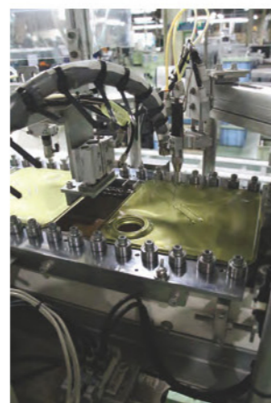
天板内面補修塗装機の細いノズルが、塗料を無駄なく迅速に塗っていく様子
