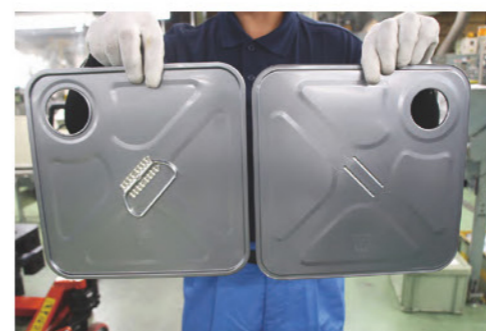
18ℓ缶の手環取付金具部分（左）と、ディスペンサ方式で塗装された手環取付金具の裏側部分。必要な部分のみしっかりと塗膜が形成されている
