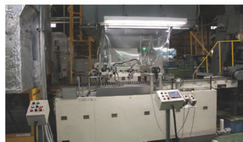
必要な部分に塗料を直接塗る「ディスペンサ方式」を用いた天板内面補修塗装機
