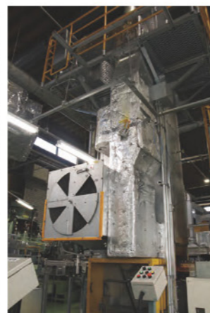
天板内面補修塗装機と併せて導入した乾燥機。機械を通過する3分以上でしっかりと乾燥させることができる
