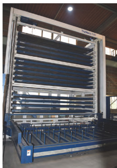
パレットチェンジャーには全部で15段分の切断用の鉄鋼がセットされている
