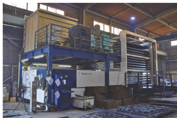
夜間に自動で作業を進める自動材料供給搬送装置「パレットチェンジャー」を導入
