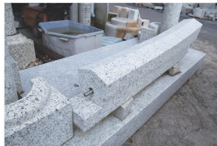
耐震加工が施された鳥居①
