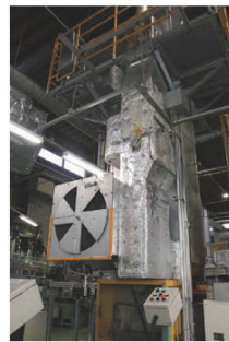
天板内面補修塗装機と併せて導入した乾燥機。横横を通過する3分以上でしっかりと乾燥させることができる
