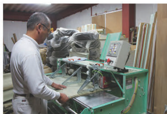
いぐさをのりをつけて切る東海機器工業㈱の「自動畳表裁断機」。これまでは包丁を使って手で裁断していた
