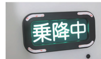
ユニバーサルタクシーに取り付けられる乗降中のライト
