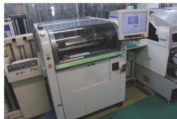
自動ハンダ印刷機SONY SI-P850。基板実装機と並んで設置されており、部品が載った状態の基板が自動的に入る
