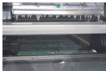
自動ハンダ印刷機がハンダ付けをする様子
