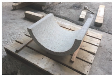
自動化された機械で曲面の加工も正確に短時間でできる
