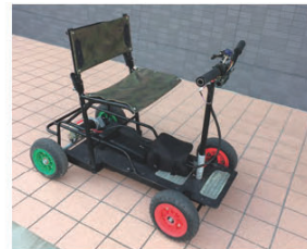
小型モビリティとして最適なタイヤの位置やタイヤとタイヤの幅、シートの取り付け場所を検討、検証するために製作した1号車
