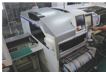
電子基板の上に高速・高精度に電子部品を装着する基板実装機FUJI NXT III
