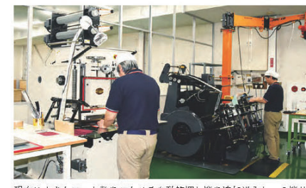
現在は大きなロット数をこなせる自動箔押し機を追加導入し、3機体制で対応
