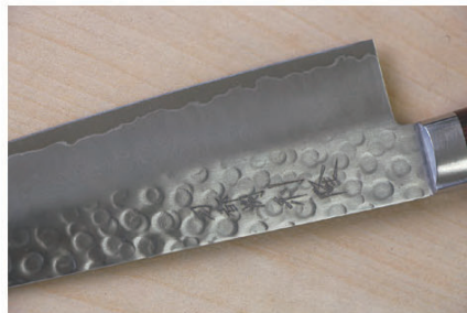
ファイバーレーザー加工機では深く彫り込むことが可能
