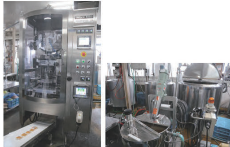
新たに導入した高速汎用性袋充填機ONP-2030AS3 300Lパステライザー
