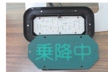
内部の電子基板は基板実装機と自動ハンダ印刷機を使って製作した
