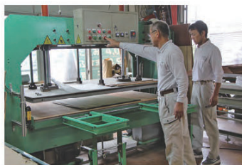
畳と芯材を挟んで貼り付けて作る東海機器工業㈱の「ヒートプレス」
