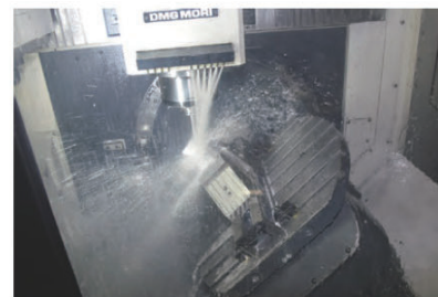
テーブルが回転傾斜することで3次元複雑形状を削り出す
