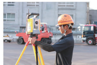
図面を3D化できる測量機器の導入で正確で迅速な測量が可能になった
