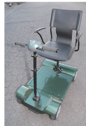
1号車の試作で得た最適寸法をベースにデザインし、下部フレームや上部フレーム（シート）を製作。2号車を完成させた
