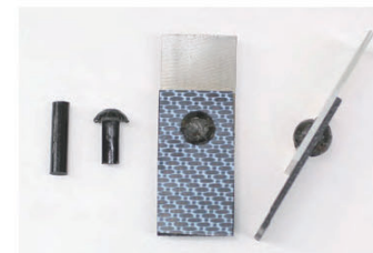
CFRTPリベットによる締結
