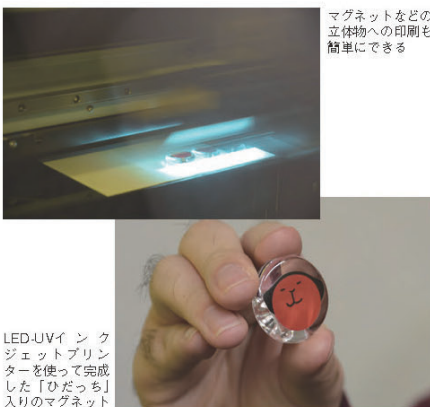
立体物への印刷が可能に「LED-UVインクジェットプリンター」を導入
