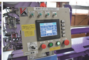
データをプログラミングされており正確な寸法で畳を製造できる
