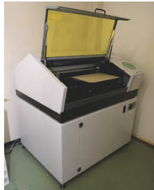
立体物への印刷が可能に「LED-UVインクジェットプリンター」を導入
