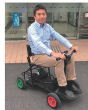
小型モビリティとして最適なタイヤの位置やタイヤとタイヤの幅、シートの取り付け場所を検討、検証するために製作した1号車
