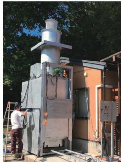
50kgを超える大型犬などにも対応できる新たに導入したペット火葬炉
