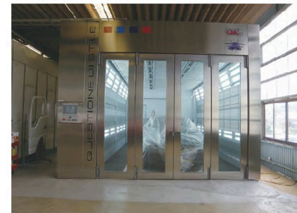
水性塗料専用の塗装・乾燥設備
