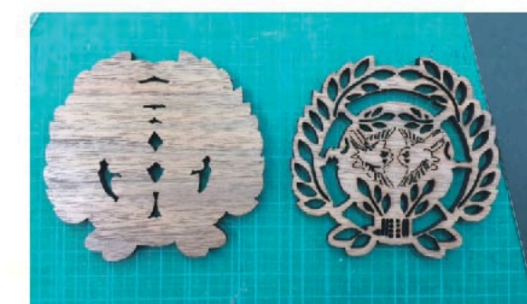
左が外注による加工、右が社内による加工。社内加工では、裏面まで抜き・彫刻が可能に。
