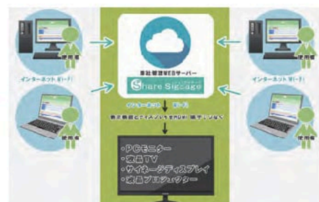
WEBシステムで、クラウドサーバーに上げた放映スケジュールとコンテンツ（画像、動画、URL）情報をディスプレイ側のミニPCが受信
