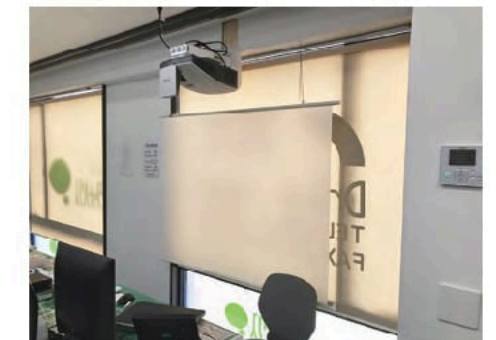
店舗等の窓やショーウィンドウに映像広告を投影できる「窓ガラスサイネージ」
