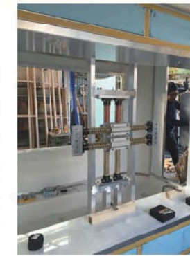
緩衝機構付モニター取り付け部（トレーラーに組み付け）
