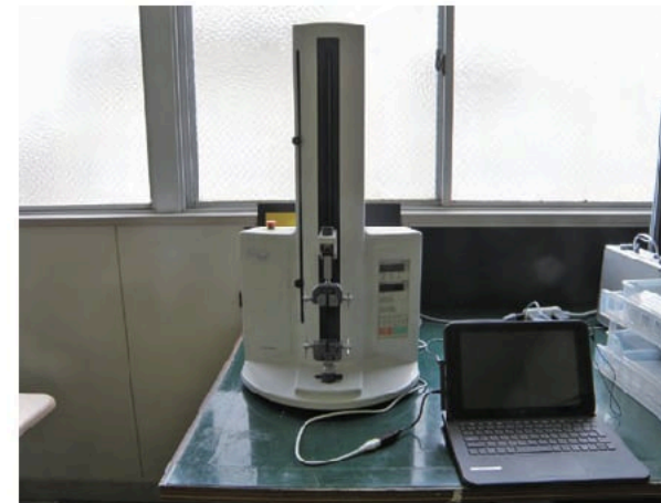
剥離力を測定する引張試験機
