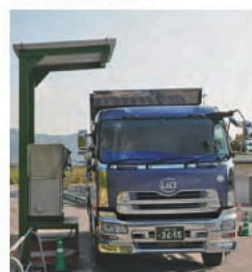
製品の積み込みを終えた車両は退場する際、計量時にカードを読み込ませ、出荷計量伝票が自動で発行される
