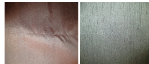
ミシン目がそろっていない (手縫い) ミシン目がそろっている (自動機)
