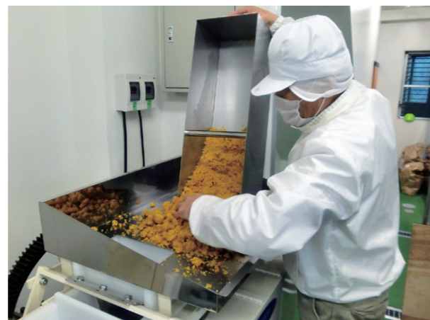
真空ミキサーで結着した大豆粉を麺帯にする工程
