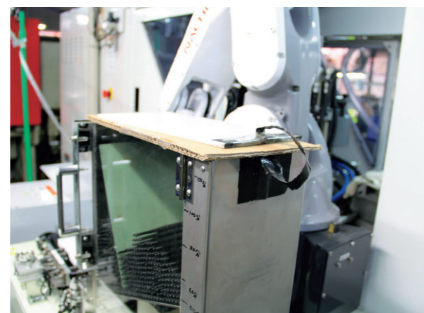
硬度の違う梵天部と軸を一体成形できるロボット成形機。プラスチック材料の温度、金型の温度、圧力などの条件設定が難しく、試作・検証を繰り返した。
