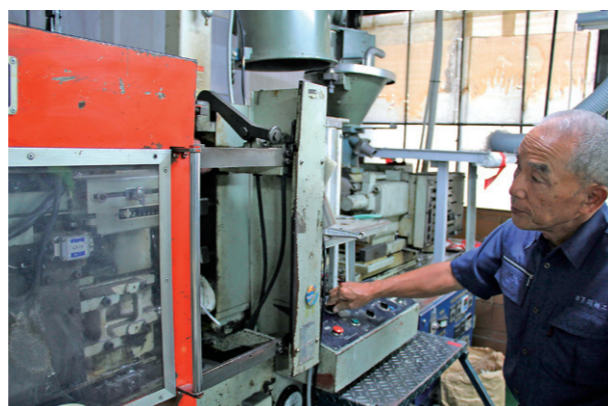
切削機や射出成形機が並ぶ工場内。プラスチック製品に特化し、金型製作から成形までの一貫生産を行う。
