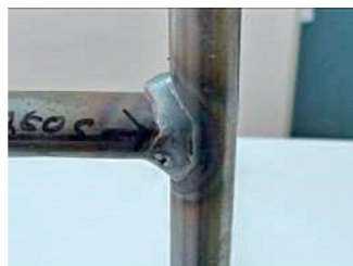
ロボット溶接機メーカーの工場で作成したフレーム。スパッタがほとんど付着せず、ビード外観も美しく仕上がることを確認できた。
